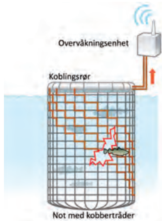
Enkelt prinsipp: Blir det et hull i nota, vil den elektriske kretsen brytes og sende beskjed videre til oppdrettsanlegget. Illustrasjon: Havtek
